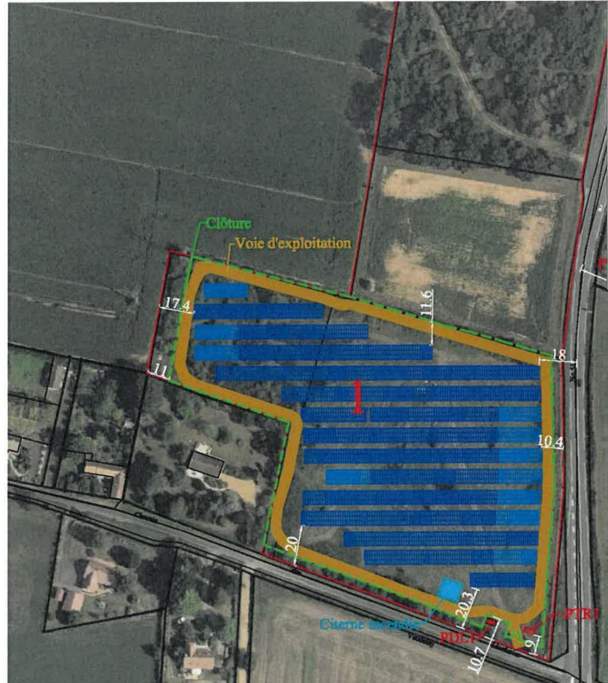
Distance minimale des panneaux par rapport à l'axe de la RD51 = 18m
